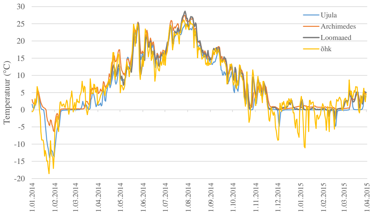
Joonis 14. Kolme haljaskatuse (Ujula, Archimedes, Loomaaed) aluskatuste ööpäeva keskmised temperatuurid ja õhutemperatuur (Archimedese kergmurukatuse kohal mõõdetuna) uurimisperiodil (01.01.2014 – 01.04.2015). Loomaaia katuse mõõtmised algasid 14.04.2014.
