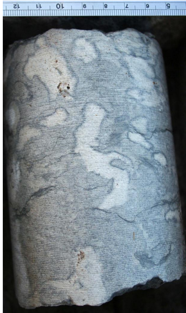
Foto 1. Dolokivi püriitse impregnatsiooniga. Sügavus 4,5 m.
