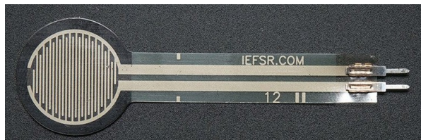
Joonis 2: Ameerika ettevõtte Adafruit FSR (Force Sensing Resistor) sensor (sensori ümar osa on ligikaudu läbimõõduga 1 cm). See koosneb juhtivast tahmapigmendi-sisaldusega polümeerist, mille ühe külje vastu on asetatud kaks kammelektroodi[10].
