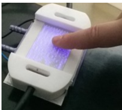
Joonis 5: Vesijahutusega dielektrik-barjäärilahendus (TÜ Füüsika Instituudi gaaslahenduslabor). Seadme aktiivne pindala oli ligikaudu 4 cm x 6 cm.
