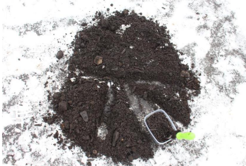
Joonis 7. Proovi massi vähendamine sektoriteks jaotamise teel
