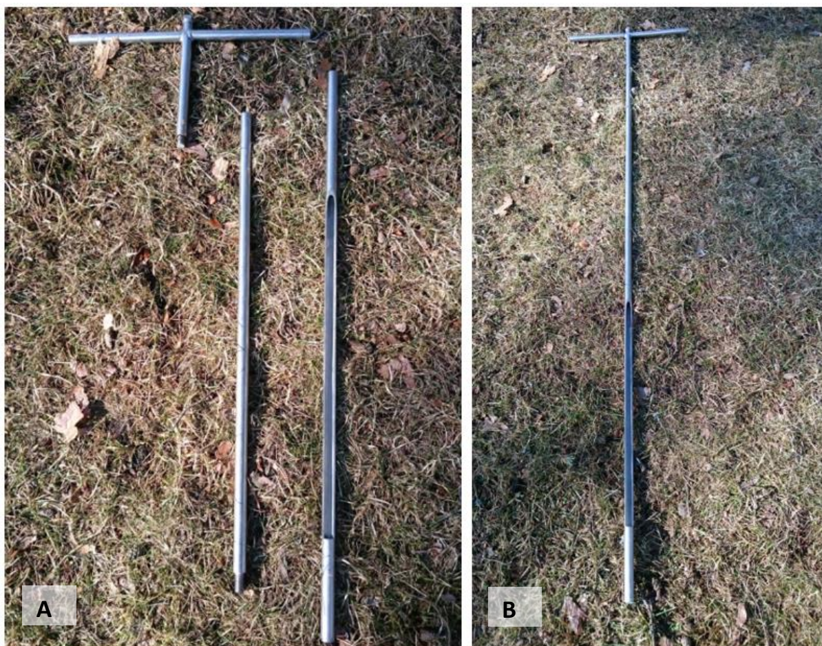
Joonis 5. Roostevabast terasest proovivõtu toru pinnaseproovide võtmiseks: A – proovivõtutoru osadena; B – proovivõtutoru kokkupanduna
