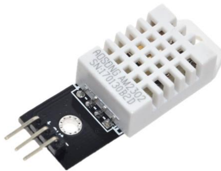
Joonis 14: DHT22/AM2302 Temperatuuri- ja niiskusandur
