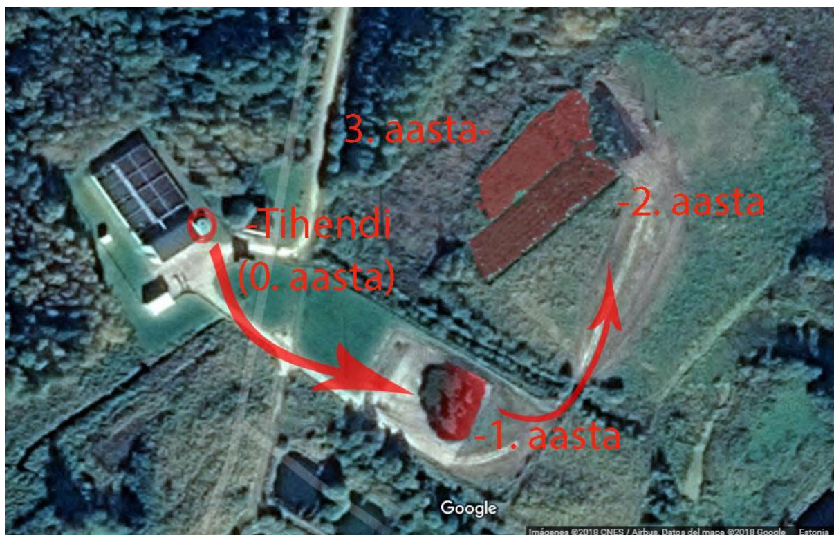
Joonis 7: Türi reoveepuhasti humifitseerimisväljakute üldine skeem.
