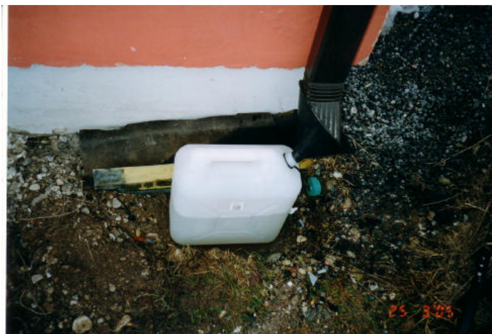
Joonis 30. Äravoolu mõõtmine murukatusest (mk2 äravool).
