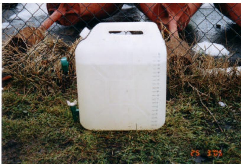
Joonis 31. 20 l kanister varustatuna liitrite mõõdikuga.
