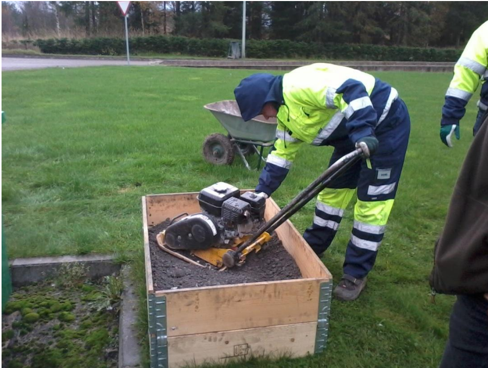
Joonis 3. Katsekasti rajamine – materjali tihendamine vibroplaadiga.
