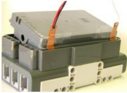
Joonis 9. Energiamõõdiku ühendamine robotiga
