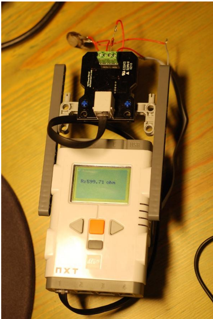
Joonis 23. Energiamõõdik potentsiomeetri takistust mõõtmast
