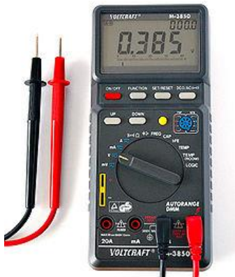
Joonis 2. Multimeeter, mis on seatud pinge mõõtmiseks
