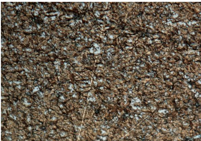
Foto 4. Söövitatud mikrolihv kuljuse ristlõikest. 500x suurendus.
