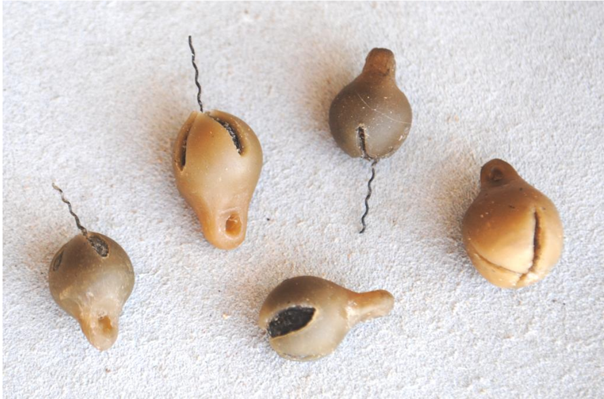
Foto 6. Savisegust südamiku sulavahasse kastmisega valmistatud mudelid
