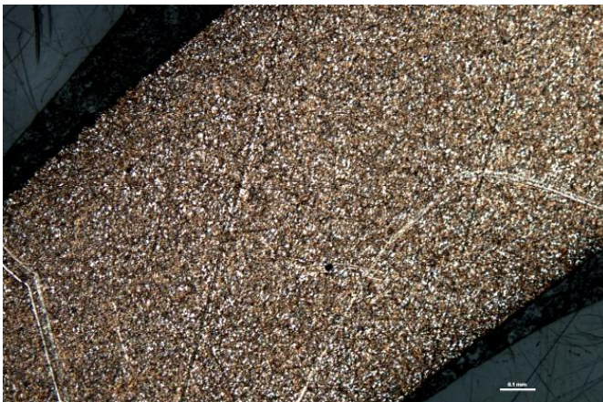
Foto 3. Söövitatud mikrolihv kuljuse ristlõikest. 100x suurendus.
