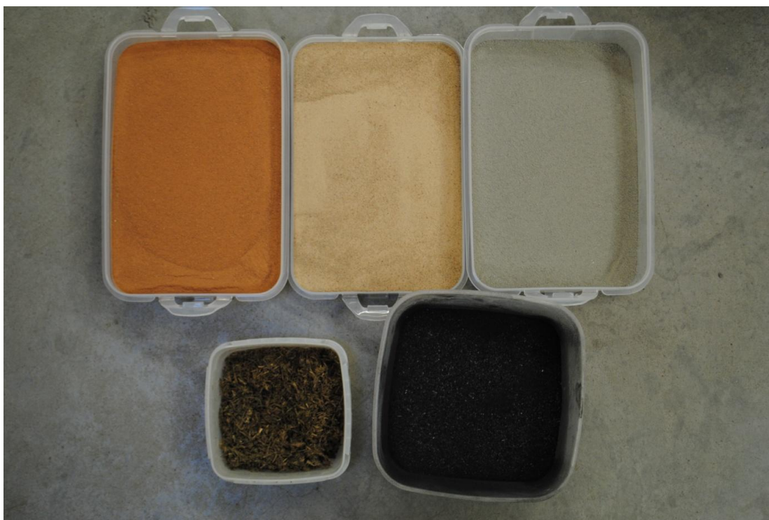
Foto 5. Sõelatud ja peenestatud vormimaterjalid. Üvalt päripäeva: 1) punane savi, 2) liiv, 3) segu sinisest savist, liivast ja sõnnikust, 4) hobusesõnnik, 5) süsi
