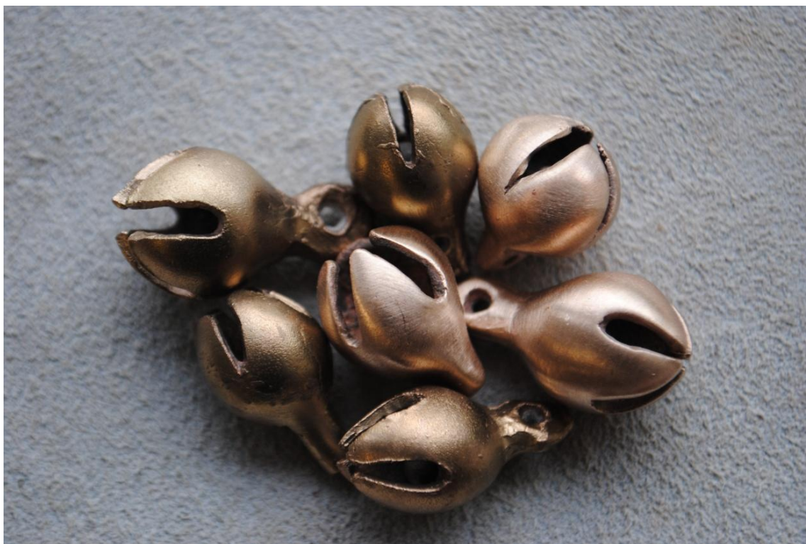
Foto 12. Vaakumvalu meetodil valatud kuljused, mille mudel on valmistatud savist südamikku sulavahasse kastes. Tumedamad töötlemata, heledamad kergelt lihvitud.
