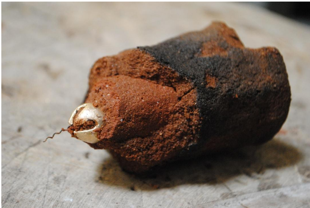
Foto 7. Kaduva vaha meetodil kinnises vormis valatud kuljus.
