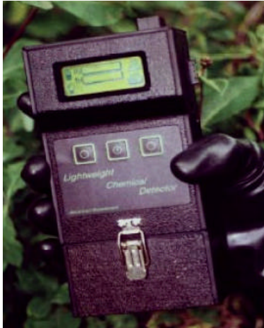
Ioonide liikuvusanalüüsil põhinev mürgaasidetektor.
