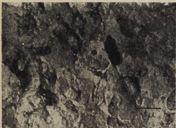
Рис. 4. Электронномикроскопический снимок методом реплика с поверхности ориентированного препарата (обр. Мьяра 79). Преобладают высокодисперсные частицы гидрослюдь размером 0,2—0,4 \mu , но встречаются и отдельные более крупные пластинки. Частицы имеют форму изометричных пластинок, большей частью с недостаточно четкими линиями ограничения.
