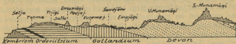
34. joonis. Eesti geoloogiline läbilõik põhja—lõuna suunas. Ülikõrgenduse tõttu näib kihte kallakus väga palju suurem kui tõeline, samuti on maapinna reljeef silmatorkavalt järsk. Jääaegsed ja pärastjääaegsed setted pinnal ebapideva kattena.
