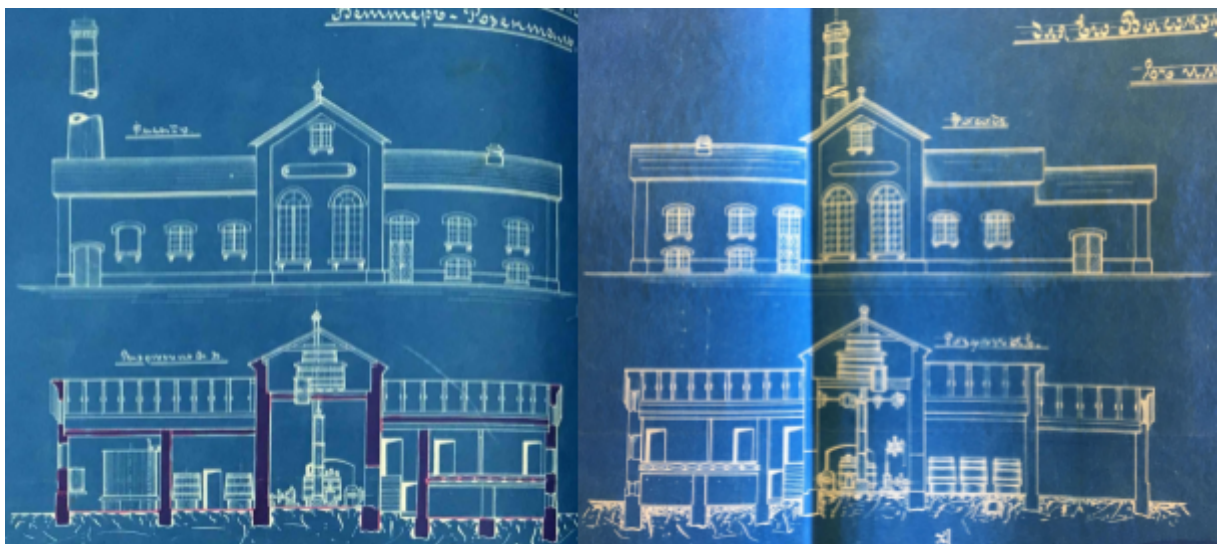
Järve (1904) ja Kärssa (1905) mõisa viinavabrikute esifassaad ja läbilõige. Detail ehitusplaanist. Fotod: Eliisebeth Pruus.
