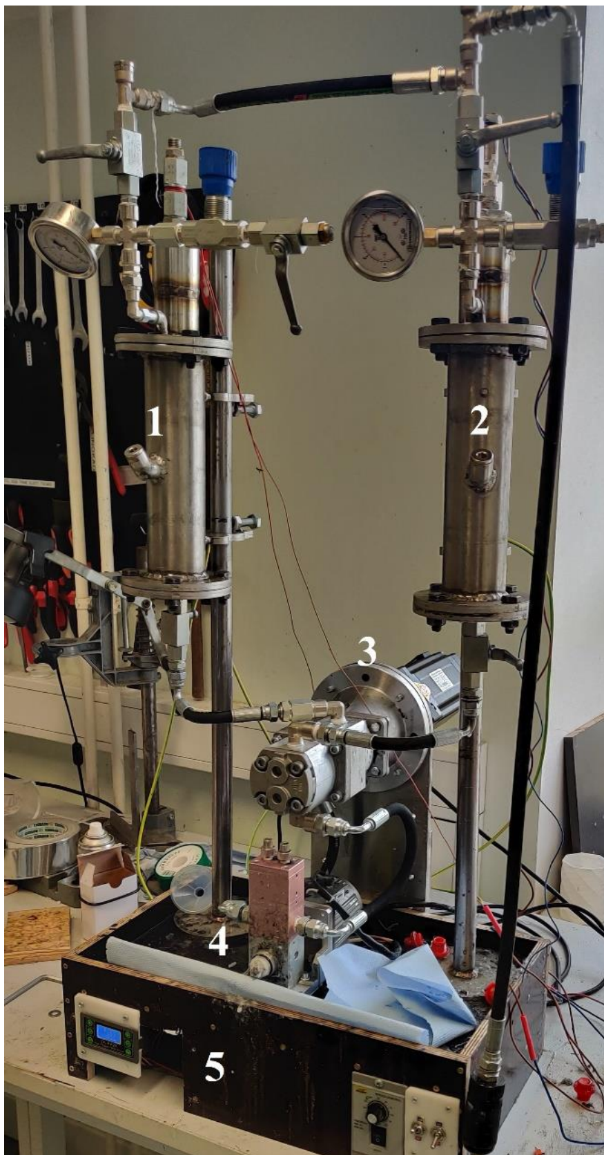
Pilt 3. Teise põlvkonna prototüüside. 1, 2- surve all olevad anumad, 3- pump, 4- väljumisava, 5- kontrollid
