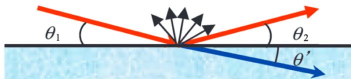
Joonis 5. Röntgenkiirguse peegeldumine, murdumine ja hajumine proovile langedes [44].
