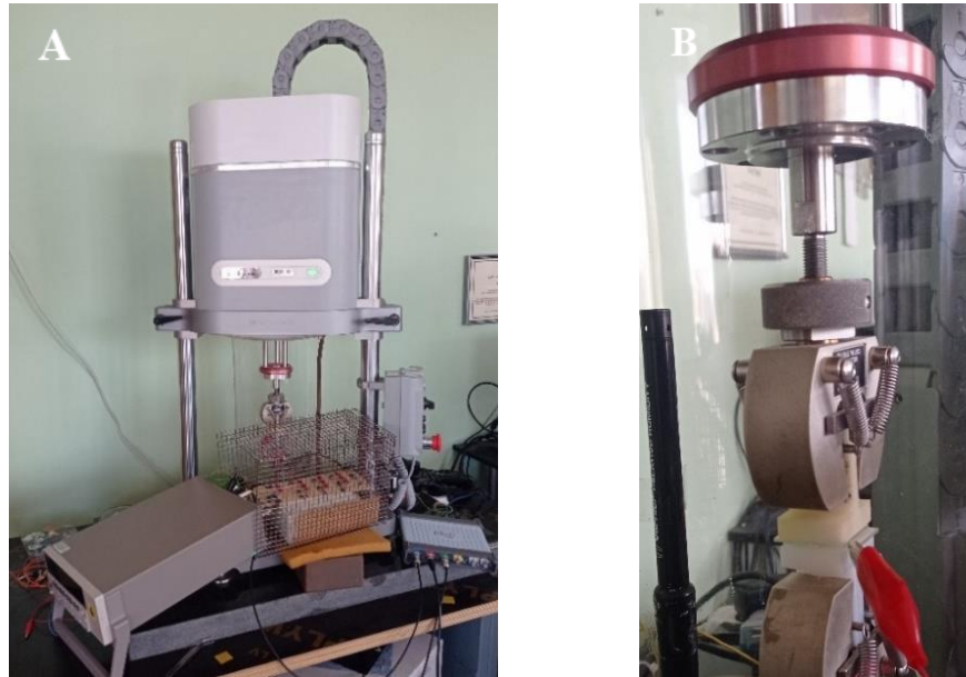
Joonis 7. A – seade materjalide triboelektriliste omaduste mõõtmiseks. B – suurendatud osa seadmest PGS polümeerkile kontakti viimisest indium-tinaoksiidkilega kaetud klaasi pinnaga.
