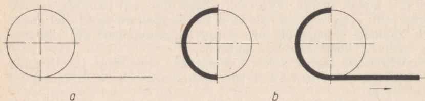
Joon. 41-4. Seostatud joonte tušiga katmise järjekord: a — eeltöö pliiatsis; b — tušiga kaetakse enne kaar, siis sirge.
