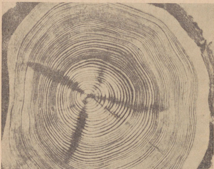
Joon. 26. Männitüve läbilõige, mis näitab, et aastaringide laius muutub üheteistkümneaastase perioodiga.
