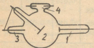
Рис. 6. Разрез ионной трубки.
