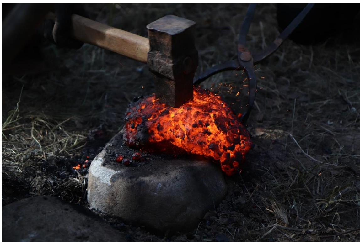
Foto 32. Poorse käsraua esmane sepistamine alasikivil Rookse eksperimendil 2023. aastal.
