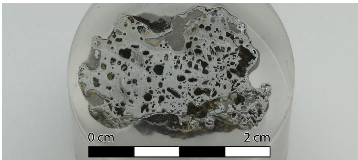
Joonis 4. Käku ML 157 šlakiproovi ristlõige.
