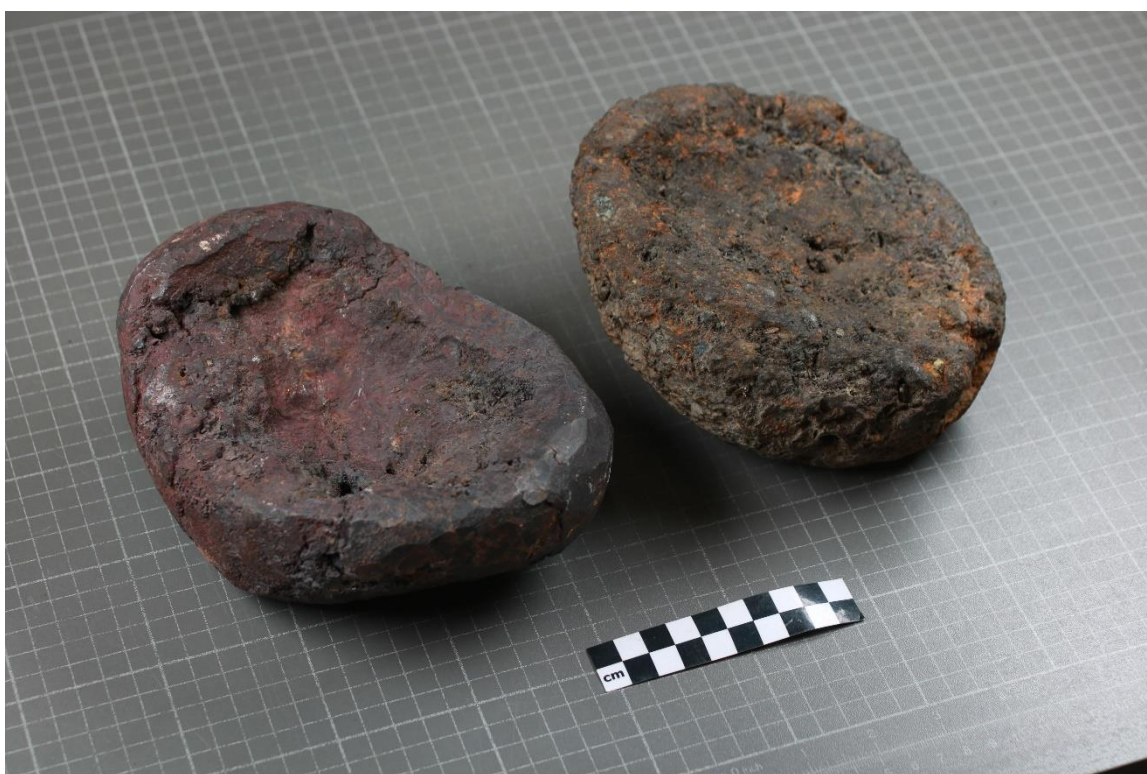
Foto 33. Rookse 2023 eksperimendil valminud 5,2 kg raskune poolsfääriline rauatoorik (vasakul) võrrelduna Praaga poolsfäärilise kaubatoorikuga.
