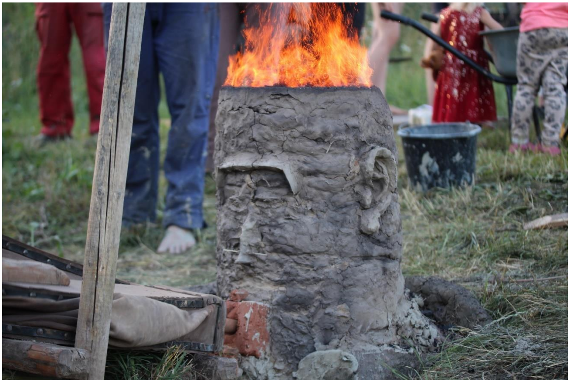
Foto 29. Rauda sulatamine Karula 2024 eksperimendil. Foto: Matasha Mazis.
