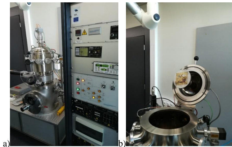
Joonis 31. (a) Elektronkiir-aurustamise seade, VS-17. (b) Seadme ülaosa kuhu kinnitatakse vastava hoidjaga objektid.
