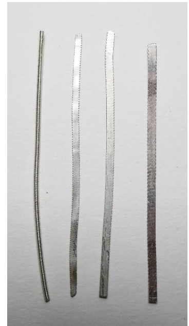
Pilt 33. 1,6 mm traadi valtsimisel saadud tulemused 2,1/2,5/2,7 mm Foto: Indrek Ikkonen
