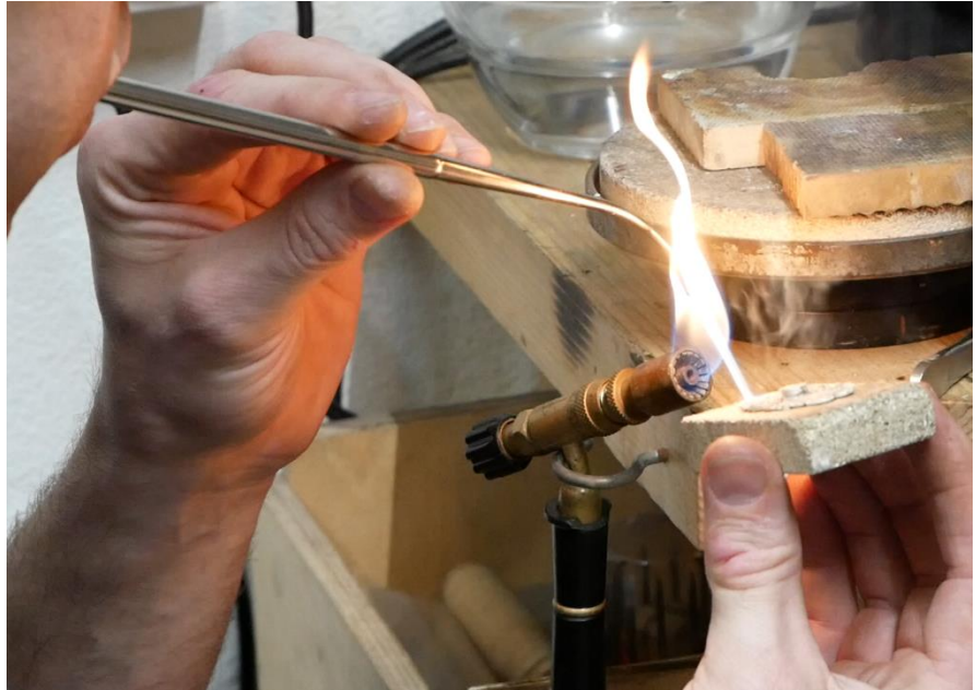
Pilt 35. Puhumistoru kasutamine detailide jootmisel Foto: Indrek Ikkonen
