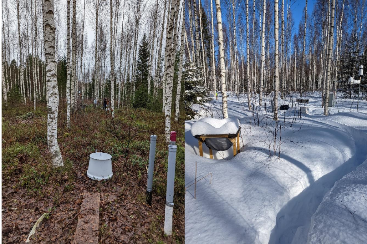
Joonis 4. Fotod Liispõllu uurimisalalt sügis- ja talveperioodil. Vasakpoolse foto keskel on gaasivoogude mõõtmiseks kasutatav rõngasse paigutatud mõõtekamber.
