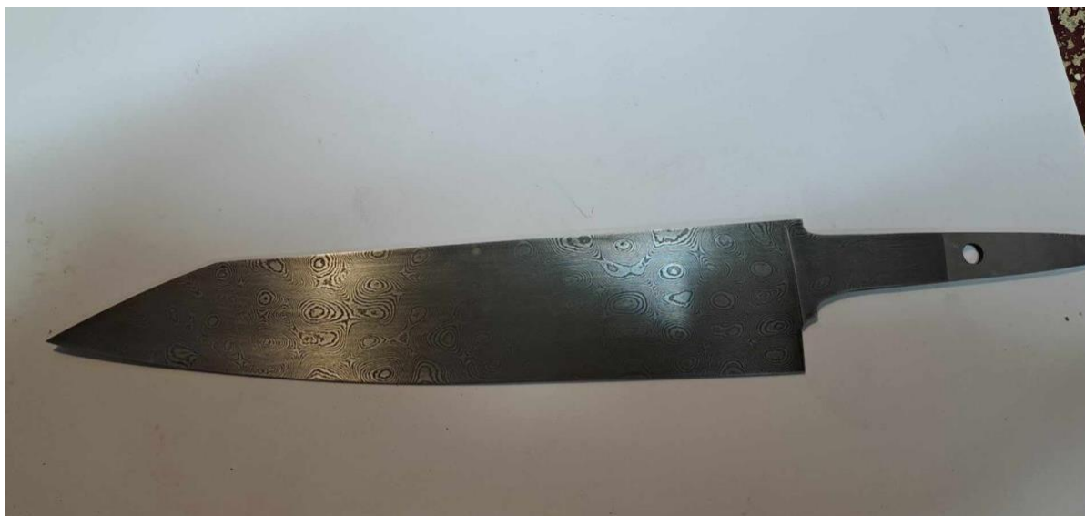
Joonis 47. Söövitatud tera (Ingmar Feldmann)
