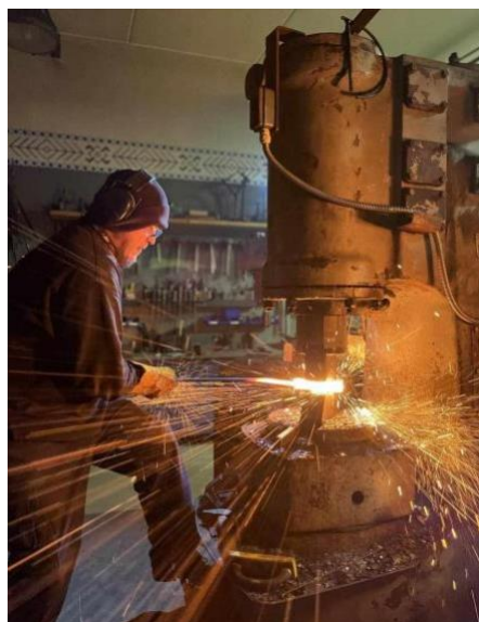
Joonis 18. Suruõhuvasaraga keetmine (Ingmar Feldmann)
