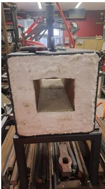
Joonis 16. Täiendava isolatsiooni lisamine (Ingmar Feldmann)
