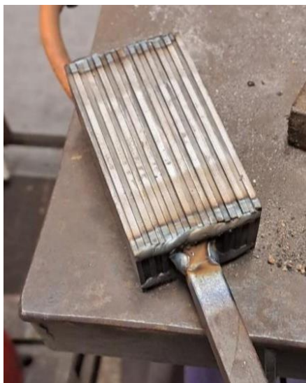
Joonis 18. Suruõhuvasaraga keetmine (Ingmar Feldmann)
