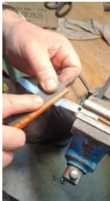
Joonis 31. Noa lihvimine liivapaberiga (Ingmar Feldmann)
