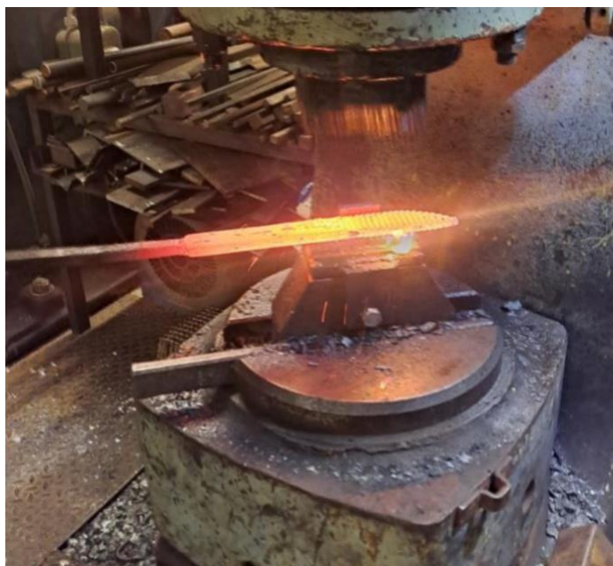
Joonis 26. Mustriraua kasutamine noatera peal (Ingmar Feldmann)
