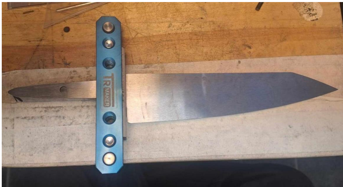
Joonis 44. Kõvasulamplaatidega abinõu (Ingmar Feldmann)
