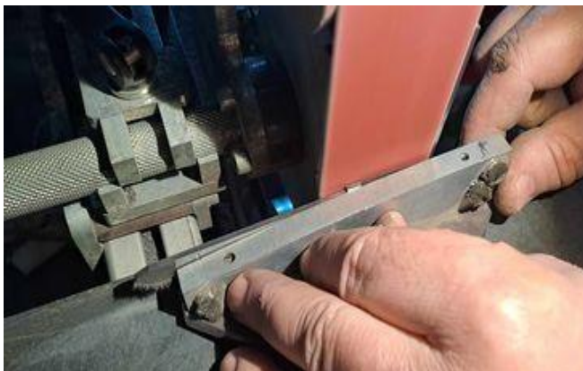
Joonis 30. Noa lihvimine (Ingmar Feldmann)
