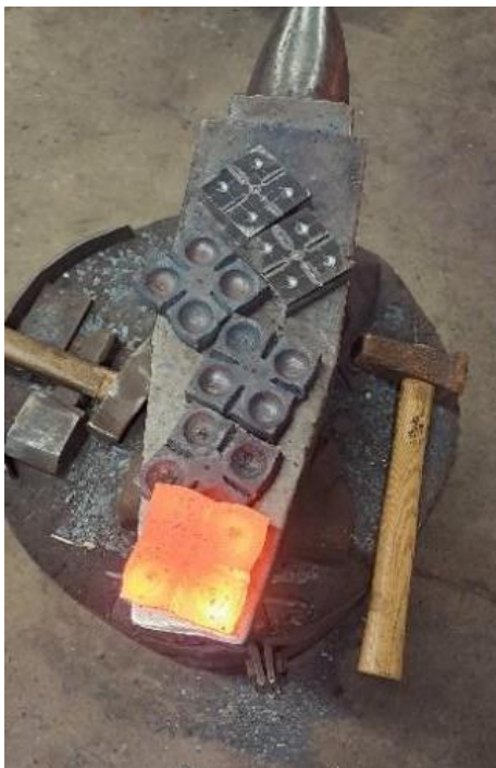
Joonis 7. Alusplaatide sepistamine (Ingmar Feldmann)
