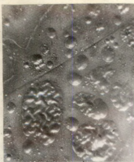
Foto 24. Alusplaadil harilik klaas + SnO 2 + SiO 2 olev fosfoorikiht.
