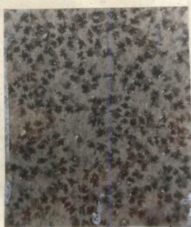
Foto 26. 550°C juures kuumutatud fosfoorikiht: C_{\text{PbCl}_2} = 2 \cdot 10^{-1} \text{ g/g } \text{ЭЛ-510} d = 1 \mu\text{m} ; t = 30 \text{ min.} ; alus- plaat - harilik klaas + \text{SnO}_2 .
