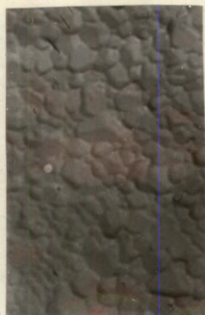
Foto 2. 50 mg 3A-510 aurustamisel saadud fos- foorikiht: T=750°C; alus- plaat -LK-5; suurendus 10000x.
