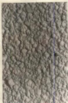
Foto 4. 50 mg 3A-510 aurustamisel saadud fos- foorikiht: T=750°C; alus- plaat -LK-5+SnO 2 ; suurendus 10000x.
