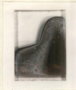
Foto 16 Fosfoorikihiga alusplaat pärast kloori ja inertse gaasi segus kuumutamist. Kloori kvartstorru sisselaskmine toimus 500^{\circ}C juures.
