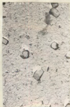
Foto 7. Kloori ja argooni segus kuumutatud fosfoorikiht: kloori sisselaskmise temperatuur oli 150^{\circ}\text{C} ; esines nõrk fotoluminestsents.
