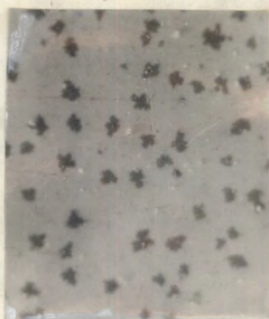
Foto 27. 650°C juures kuumu- tatud fosfoorikiht: C_{\text{PbCl}_2} = 2 \cdot 10^{-1} \text{ g/g } \text{ЭЛ-510} ; d = 1 \mu\text{m} ; t = 30 \text{ min.} ; alus- plaat - harilik klaas + \text{SnO}_2 .
