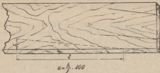
Joonis 4. Kaldtoime mõõtmise viis laua juures. a — kaldtoimelisus %-ides, h — kiudude kõrvalekaldumine pikkuse 1 meetri kohta sentimeetrites.
