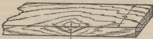
Joonis 6. Kurru mõõtmine tangentsiaalselt saetud laual.
