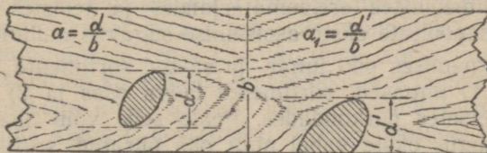
Joonis 2. Laua servale mitteväljaulatava või väljaulatava oksa mõõtmine lauas. a ja a_1 — okste suhtelised mõõdetud (laua laiuse osades); d ja d_1 — oksa absoluutsed mõõdetud millimeetrites, mõõdetuna risti sortimendi teljele; b — laua laius millimeetrites.
