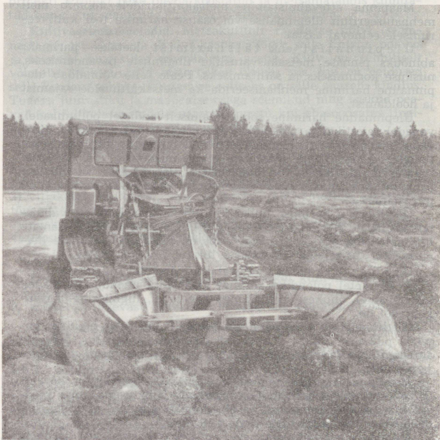
Joonis 45. Maapinna ettevalmistamine ripp-metsakraaviadraga ПЛКН-500.
