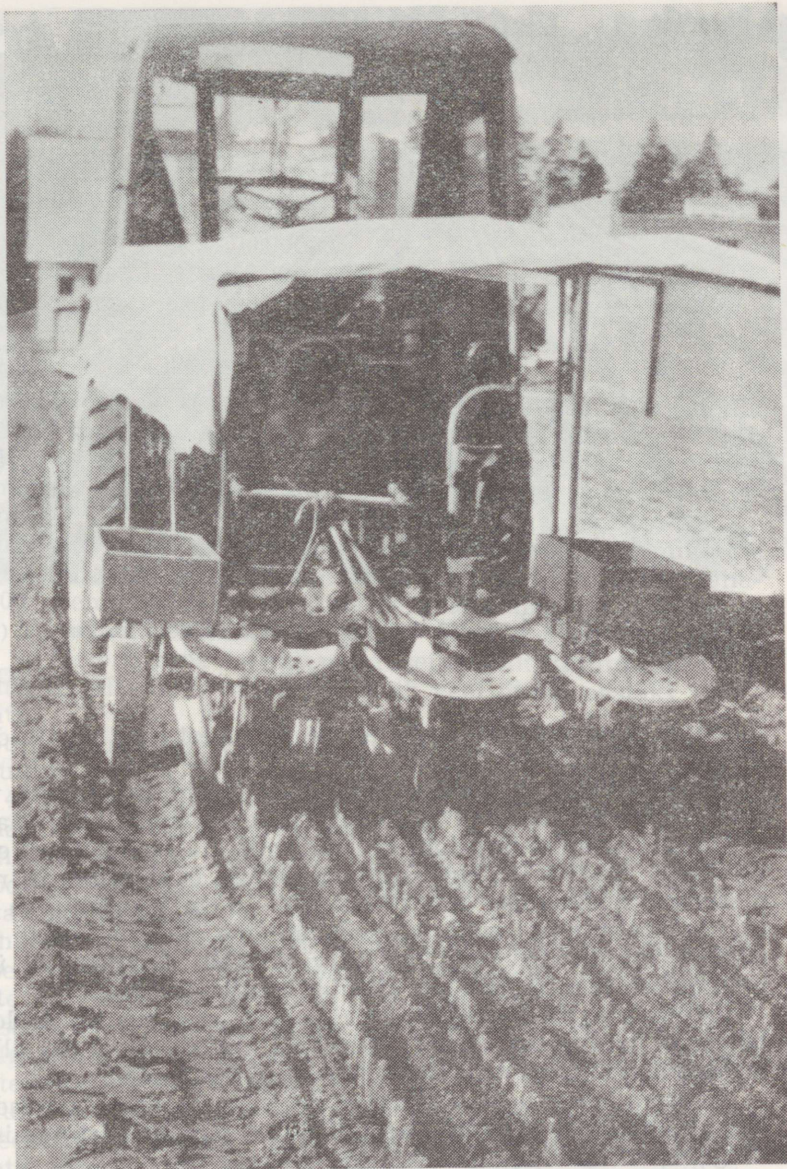
Joonis 42. M. Reimi konstrueeritud 5-realine koolitusmasin. Bidade vahekaugus 25 cm, taimede kaugus alates 8 cm-st 8-cm astmetega.
