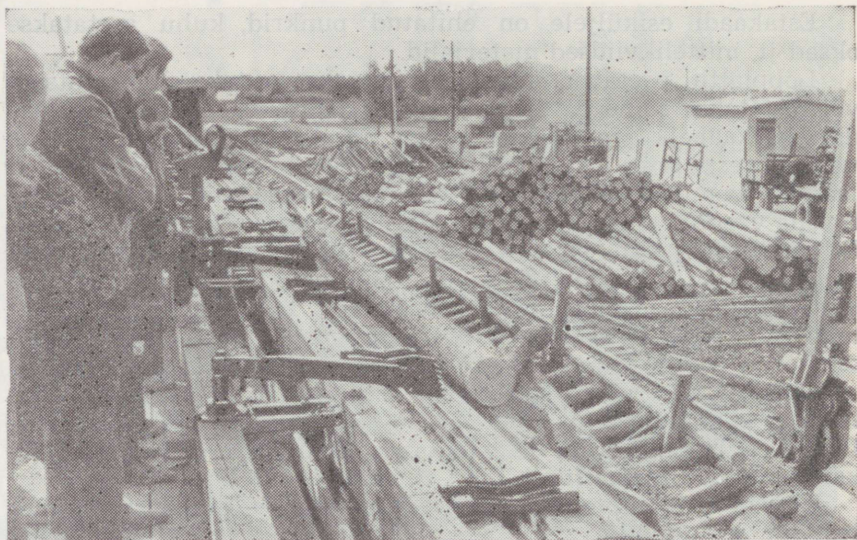
Joonis 36. Lõppladu. Metsamaterjalide sorteerimine elektromehaaniliste palgitõukuritega. (L. Tarangu foto.)
