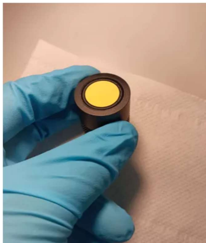
Joonis 13. Mõõdetav pulber ettevalmistatuna hajusa peegelduvuse mõõtmiseks
