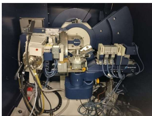
Joonis 9. Vasakul röntgendifraktomeeter, paremal publitseeritud joonise põhjal modifitseeritud skeem röntgendifraktomeetri tööpõhimõttest (Andualem 2020).
