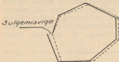
Joonis 53. Sulgemisviga ja selle kõrvaldamine
