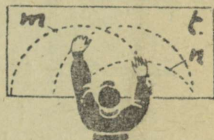
Joon. 18. Töötamisringid, mis dikteerivad tööriistade asetuse m — maksimaalne töötamisring, n — normaalne töötamisring, t — töötasapind.
