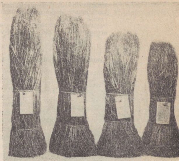
Joonis 26. Võru Toorlinavabrikus valmistatud leotamata linavarte etaloonid. Linavarte numbrid on (alates vasakult): 1,50; 1,25; 1,00 ja 0,75.
