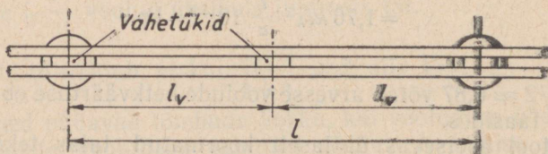
Joon. 47. Kahest vardast kogumislatt vahetükkidega tugiisolaatoritel.
