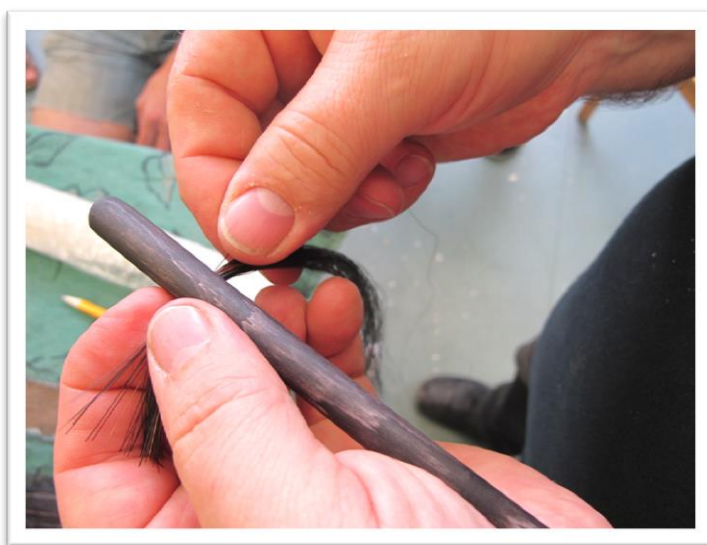
Poogna jõhvide paigaldamine
