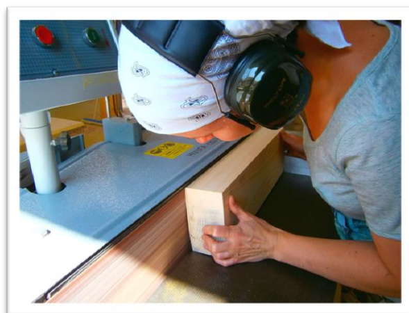
Korpuse kaaneosa kumeraks lihvimine lintlihvijaga
