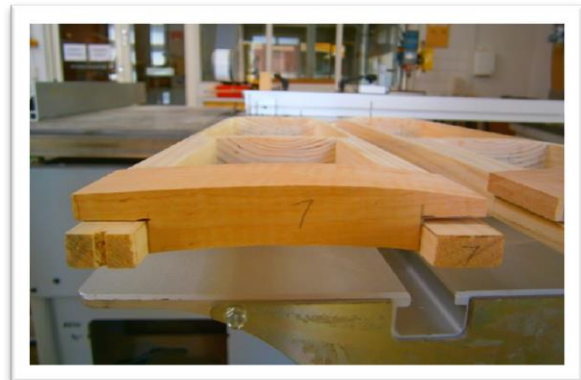
Aisade ja põikpuu seotiste sobitamine
