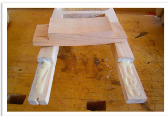
Põikpuu liimimine puiduliimiga
