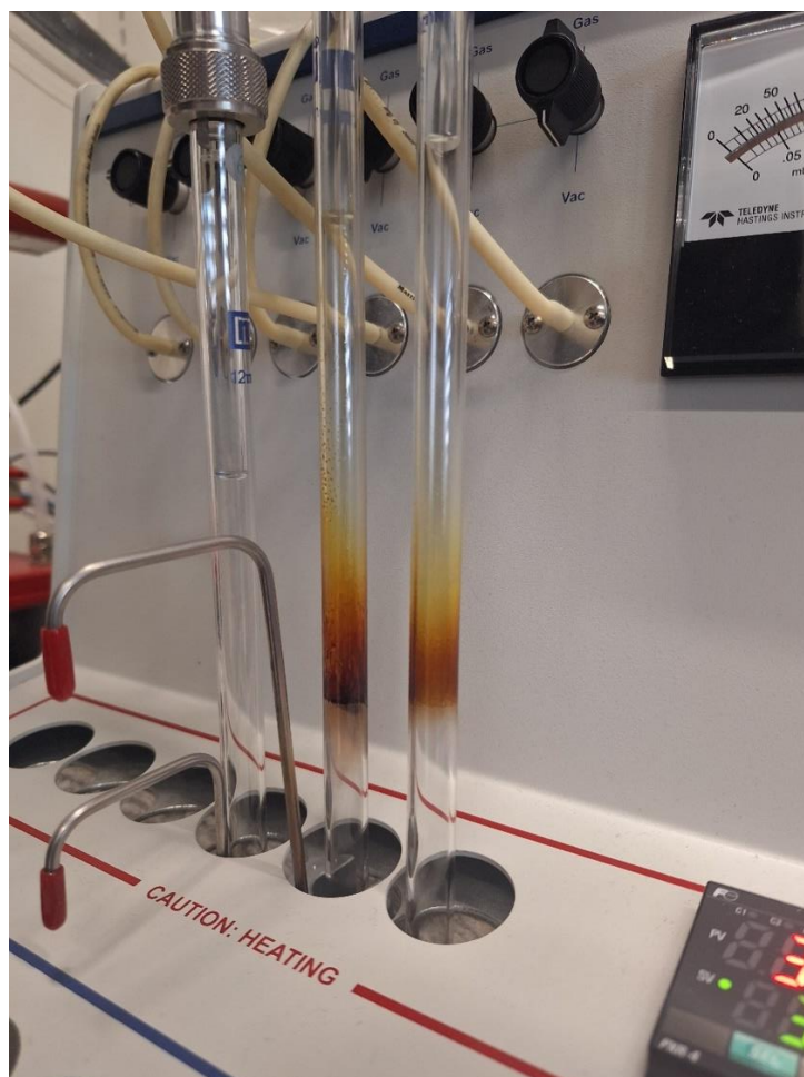
Joonis 6. Temperatuuril 300 °C degaseerimisel eraldunud lisandid kolvi seintel
