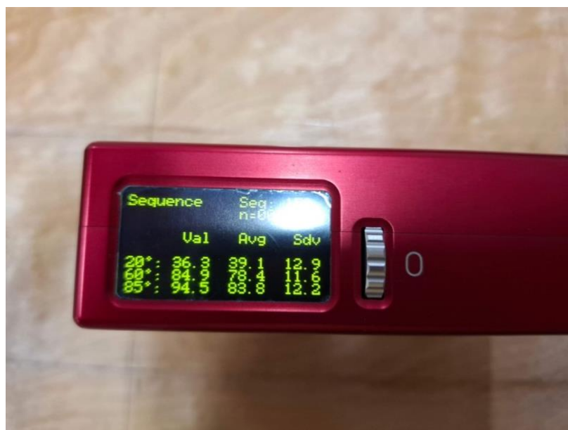
Joonis 16. Laki läike mõõtmine Zehntner ZGM 1110 Glossmeteriga. Foto: Tiit Raik
