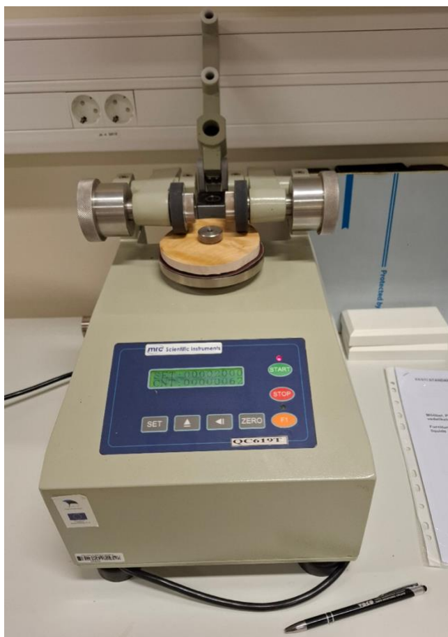
Joonis 19. Viimistluskihi abrasiiooni tester MRC Scientific Instruments QC619T. Foto: Tiit Raik
