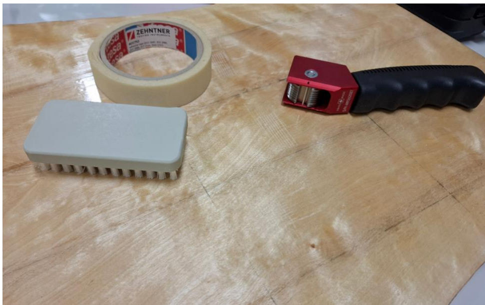
Joonis 18. Zehntner ZCC 2097 Cross-cut viimistlumaterjali nakketestri komplekt. Foto: Tiit Raik
