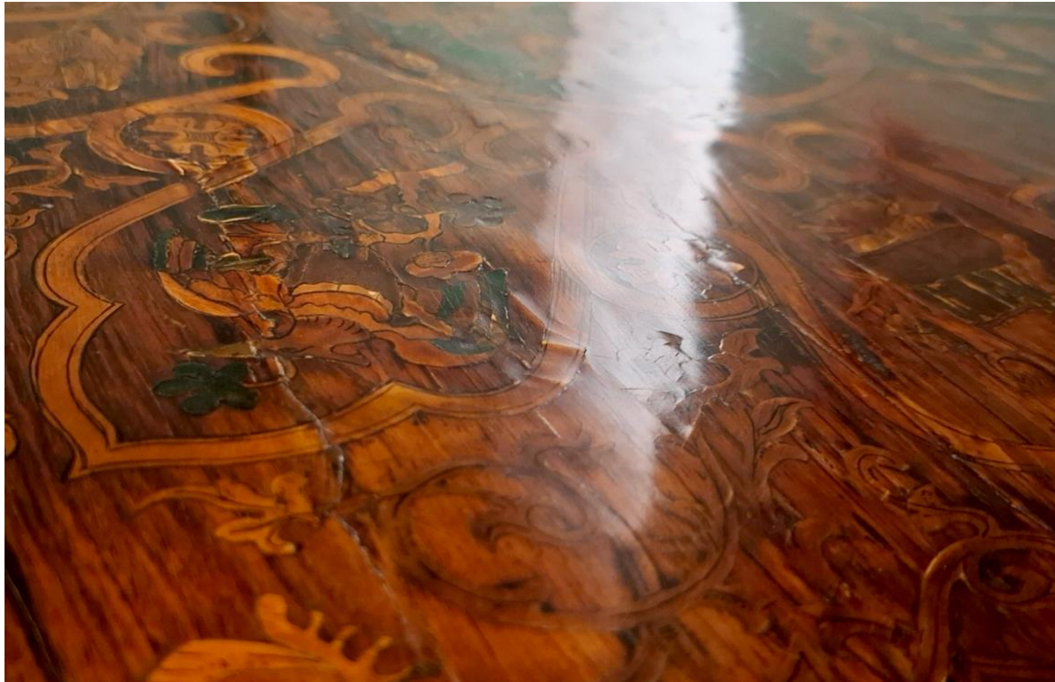
Joonis 1. Pragunenud lakikiht. Rokokoo stiilis laud, Rakvere mööblimuuseum (Virumaa Muuseumid, RM 6572 Aj 1094:10). Foto: Tiit Raik
