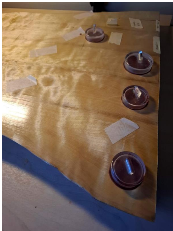
Joonis 21. 25mm ja üks 40mm tass erinevate piirituslakkide peal. Punase veini 24h test.
