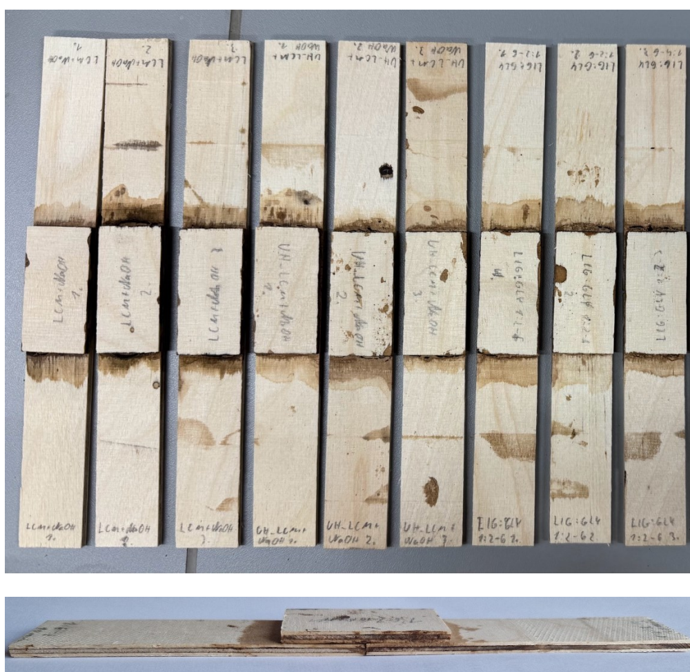
Joonis 4. Nihketugevuse määramisel kasutatud proovid. Kahe klotsi liimimisalad on omavahel ühendatud läbi vahetüki.
