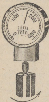
Joon. 162. Tahhomeeter. Sellega mõõdetakse tiirude arvu.
