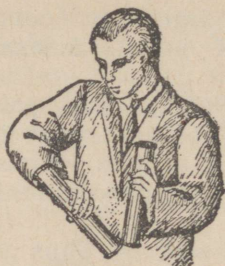
Joon. 135. Vesiniku ümbervalamine ühest anumast teise.
