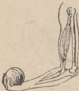
Joon. 293. Inimese käsivars on ühepoolne kang.
