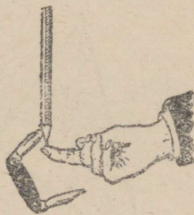
Joon. 235. Raskuskeskmes kinnitatud keha püsib tasakaalus.
