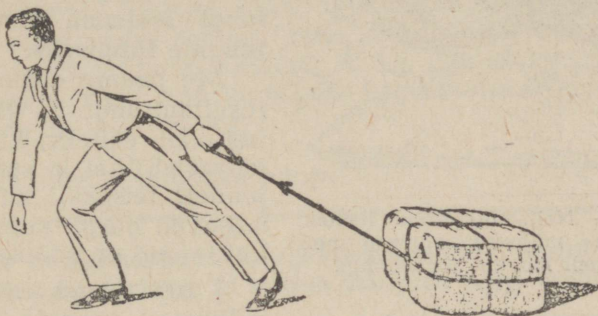
Joon. 197. A on tungi rakenduspunkt.
