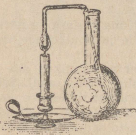
Joon. 138. Leegi seesmisest osast tulevad toru kaudu valged aarud. Seal põlemist ei ole.
