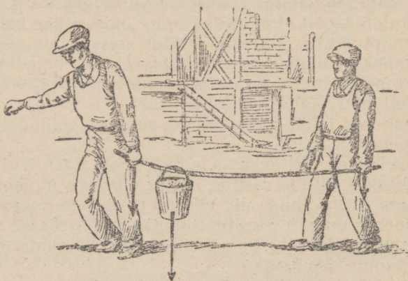
Joon. 233. Mida väiksem on koormuse kaugus toest, seda suurem on toesse mõjuv tung.
