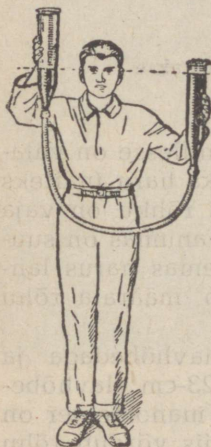
Joon. 83. Uhendatud anumate abil võib tõmmata rõhtjooni.
