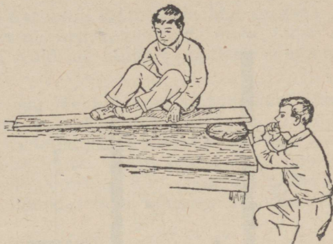
Joon. 102. Suurele pindalale jaotuv õhurõhk tekitab suurt tungi.
