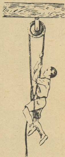
Joon. 11. Üle liikumatu ploki on pandud nõör, mille ühes otsas on silmus, kuhu on asetatud võimleja jalg, teist otsa tõmbab võimleja, tõstes iseennast.
