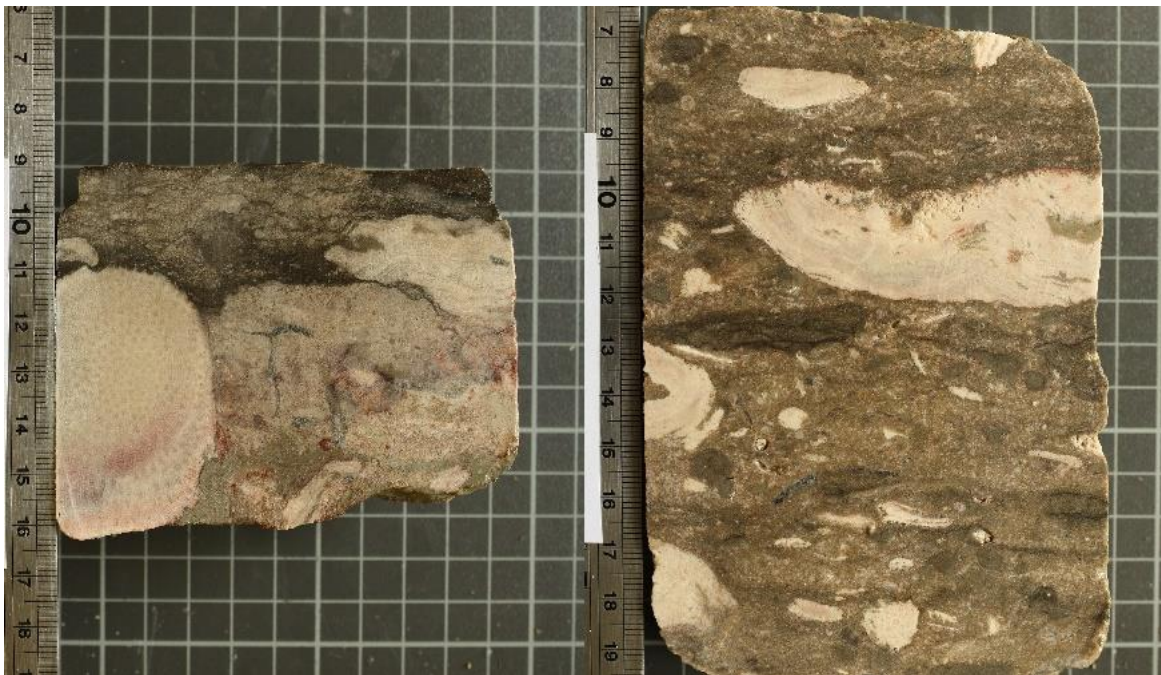
Joonis 17. Inglise (D-97) korallide ja stromatopooride bioklastid dolomiidis. Vasakul – sügavusintervall 11,65-11,70 m; paremal – 12,1-12,2 m.
