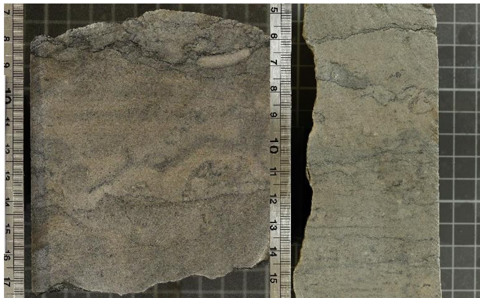
Joonis 20. Teralis-mikriitne lubjakivi. Vasakul – Lelle (D-102) sügavusintervall 72,1-72,2 m; paremal – Orjaku sügavusintervall 16,0-16,2 m.
