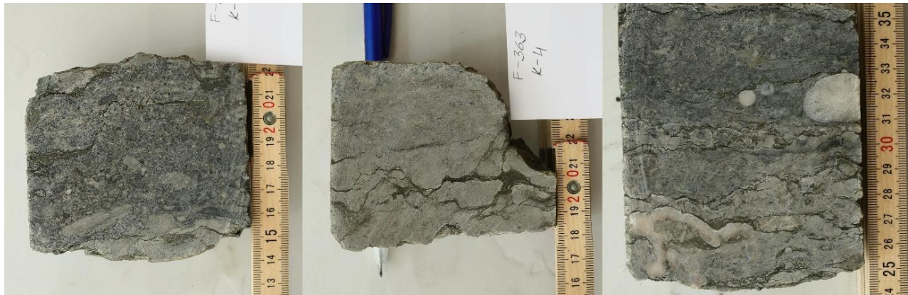
Joonis 24. Valgu (F-363) teralis-mikriitne lubjakivi bioklastidega. Vasakul – sügavusintervall 30,7-30,8 m; keskel – sügavusintervall 30,85-30,90 m; paremal – sügavusintervall 38,6-38,7 m.
