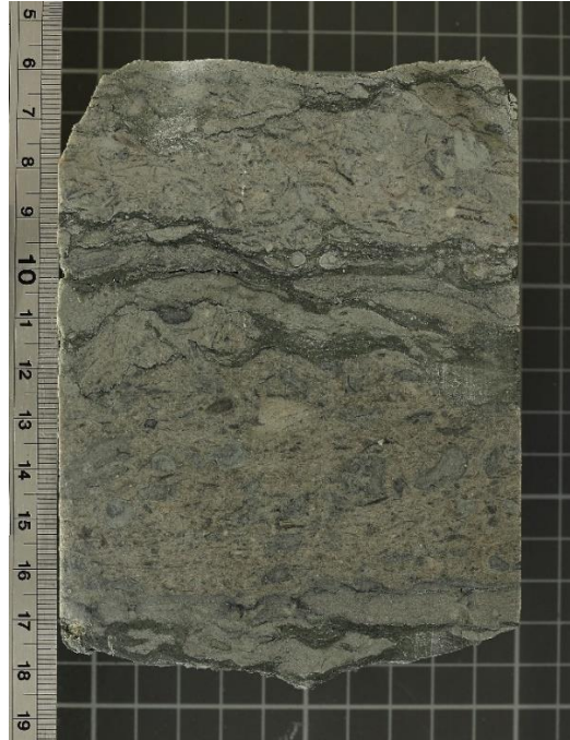
Joonis 26: Tormikihid Lelle (D-102) puursüdamiku Varbola kihistus (sügavusintervall 80,3-80,4 m)
