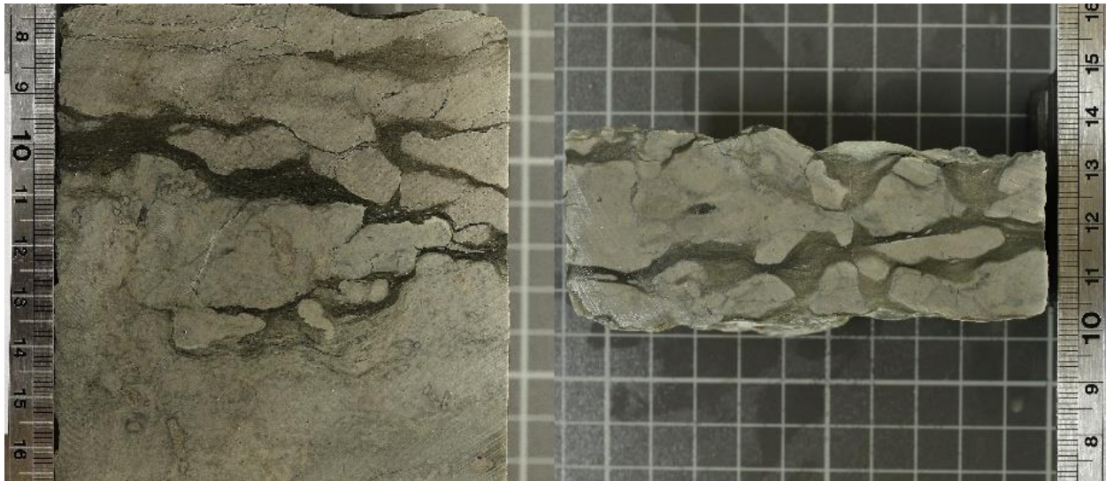
Joonis 22. Afaniitne lubjakivi. Vasakul – Lelle (D-102) sügavusintervall 67,0-67,1 m; paremal – Orjaku sügavusintervall 18,45-18,50 m.
