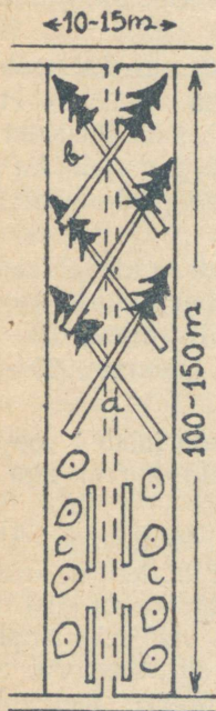
Joon. 2. Puude langetamise skeem ristamisi langetamise korral. a — algtee, b — langetatud osa vöötimest, c — töötlemata osa vöötimest (algteel materjalid valmis töödeldud).
