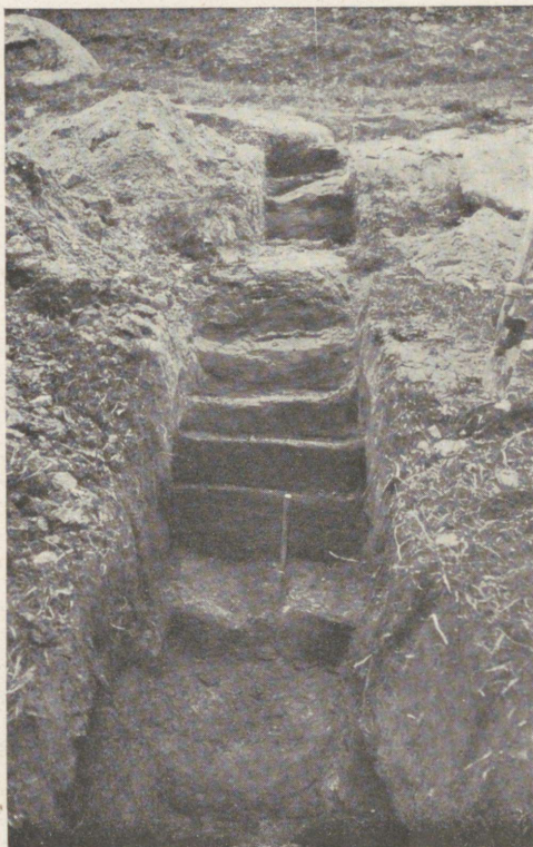
14. joonis. Keskdevoni põhikihtide läbilõik Pärnu jõe paremal kaldal Lüüsi talu kohal (XV tabel, 15). Põiksas asendis kiht — 0,10 m mergel- dolomiit, tema all 0,30 m savimergel kuni kaevami põhjani; kaevami põhi moodustub juba 1,00+ m trohhilisk-liivakivist.
