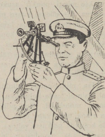
Joon. 20. Vaatluse toimetamine sekstandiga.
