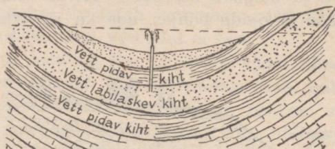
Joon. 35. Maakihtide läbilõige arteesia kaevu rajoonis. Punkteeritud joonega on näidatud vee tase vett kandvas kihis ja purske kõrgus.
