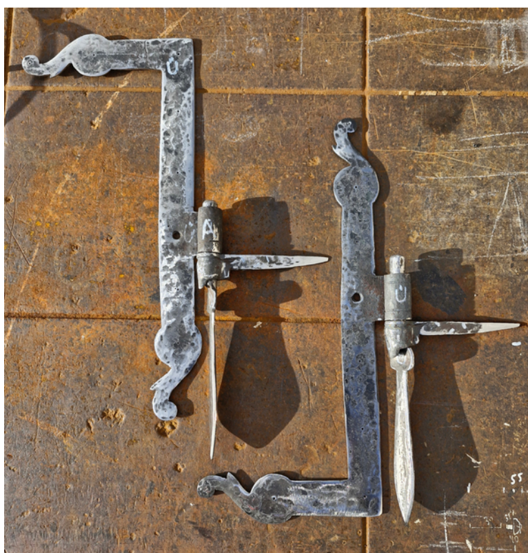
Joonis 17. Rekonstrueeritud VEEL VIIMISTLEMATA L-kujulised nurk-uksehinged. (Autori foto)
