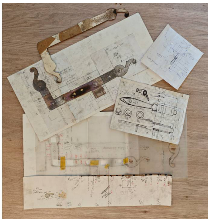
Joonis 11. Tööjoonised: kollaaž, sketš, visand, kalak mõõtandmetega, lati paksuse diagramm ja šabloon. (Autori foto)
