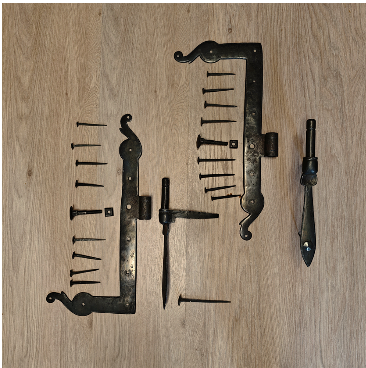
Joonis 19. Valmis kaks sepiste komplekti -- nurk-uksehingede paar, mis on Posti tn 14 (Viljandis) uksehingede rekonstruktsioon. Ühte komplekti kuulub: L-kujuine sepis-nurk uksehing, tapp ja tapisäär, polt ja mutter, naelad.
