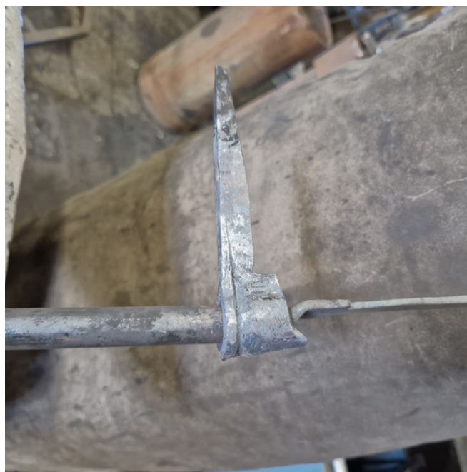
Joonis 18. Tapisääre sepistamine. (Autori foto)
