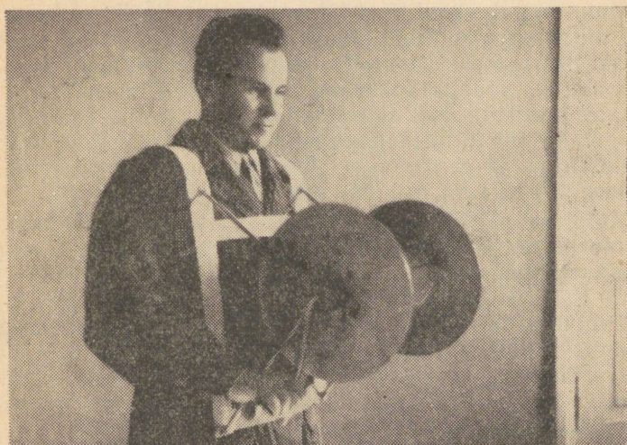
Joonis 3. Elektrikarjuse traadikerimise haspel.
