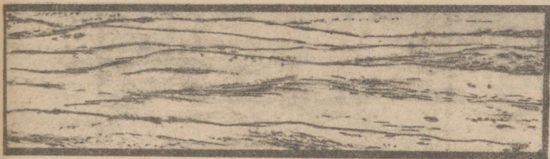
Joon. 76. Metallkiuline struktuur (mikro-ülesvõte).
