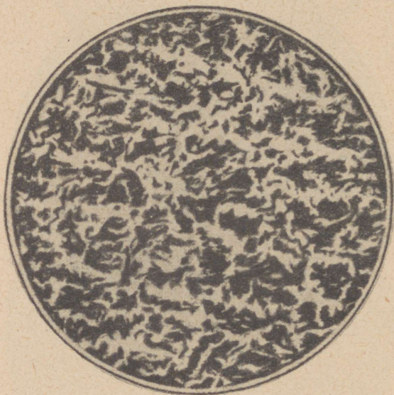
Joon. 41. Teras peeneteraline struktuur pärast lõõmutamist.
