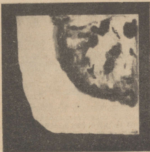
Joon. 71. Likvatsiooni näide. (Joonisel on kujutatud üks neljandik valueseme ristlõiget. Uksikud mustad täpid on gaasimullid).
