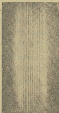
89. joon. Interferentsjooned Fresneli peeglikatse puhul.
