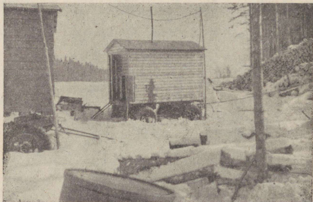
Joon. 16. Teisaldatav elektrijaam ПЭС-12-200 kinnisel järelvankril.
