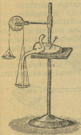
55. joon. Katse jõu määramiseks, millega juur tungib mulda.
